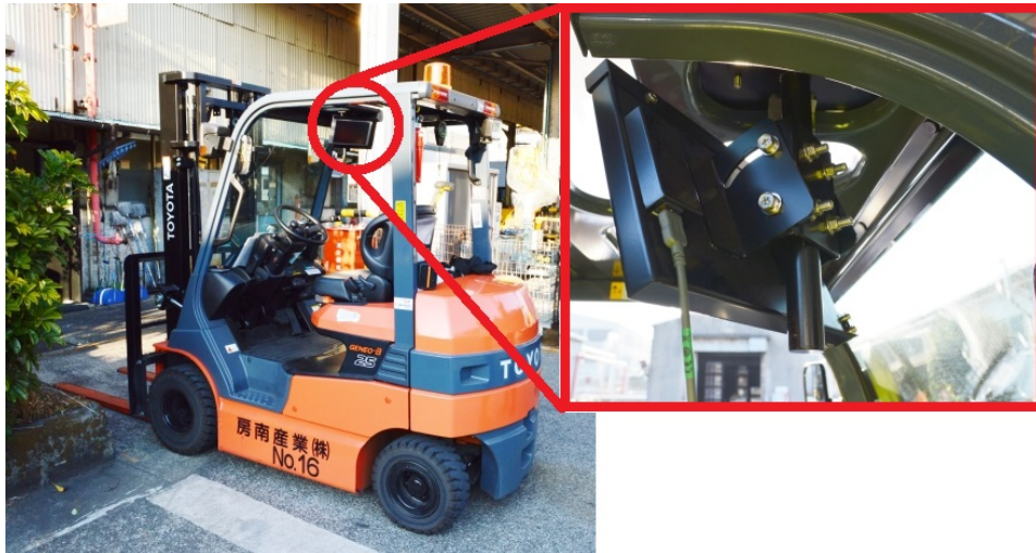
イーソル製フォークリフト端末ホルダ (EMG マーケティング合同会社 鶴見潤滑油工場にて撮影)
